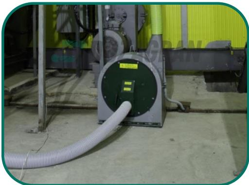
Измельчение исходного сырья до фракции размером 1-3 мм. Этап дробления позволяет снижать нагрузку на прессующий узел гранулятора и гарантировать соответствие получаемой продукции стандартам качества.
