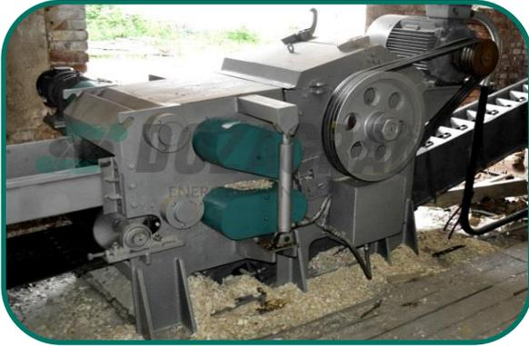
На этапе рубления происходит измельчение балансовой древесины диаметром до 400мм сначала до щепы размером 30 мм, а затем до более мелкой фракции (20 мм по максимальной стороне).
